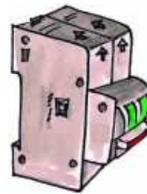
Fig. 18 - Miniature Circuit Breaker
