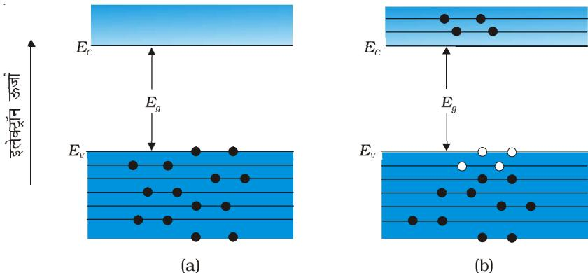
**चित्र 14.6 (a)**  $T = 0\text{ K}$  पर कोई नैज अर्धचालक विद्युतरोधी की भौति व्यवहार करता है। (b)  $T > 0\text{ K}$  पर चार तापीय उत्पन्न इलेक्ट्रॉन-होल युगल भरे वृत ( $\bullet$ ) इलेक्ट्रॉनों को निरूपित करते हैं तथा रिक्त वृत ( $\circ$ ) होलों को निरूपित करते हैं।
