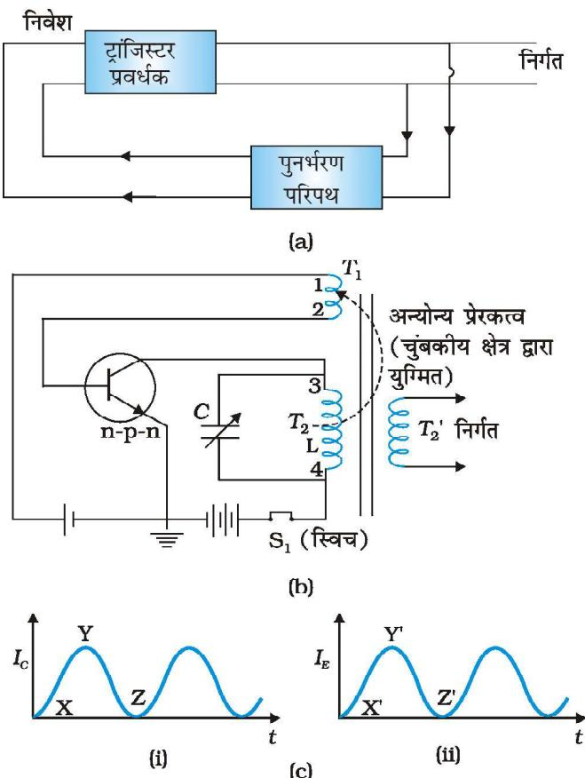
चित्र 14.33 (a) धनात्मक पुनर्भरण वाले एक स्वतः प्रतिपालित ट्रांजिस्टर प्रवर्धक का दोलित्र के रूप में क्रिया करने का सिद्धांत; (b) एक सरल  $LC$  दोलित्र (संग्राहक स्वरित्र); तथा (c) प्रेरकीय युग्मन के कारण धारा  $i_c$  और  $i_e$  का उत्थान एवं पतन (या निर्माण)।
