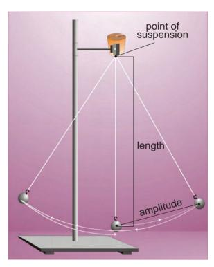
Fig 6.10. Simple pendulum
