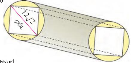
$$\begin{aligned} \therefore \text{আয়তঘনাকার কাঠের লগের আয়তন} &= \text{ভূমির ক্ষেত্রফল} \times \text{উচ্চতা} \\ &= 12 \times 12 \times 2100 \text{ ঘন সেমি.} \\ &= 302400 \text{ ঘন সেমি.} \\ &= 302.4 \text{ ঘন ডেসিমি.} \end{aligned}$$
