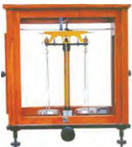
**৬. রাসায়নিক তুলাযন্ত্র :** রাসায়নিক তুলাযন্ত্র হলো কোনো নমুনা পদার্থের ঠিক ভর মাপার অথবা ঠিক ভরের পদার্থ নেবার জন্য ব্যবহৃত একটা যন্ত্র। এই তুলার সাহায্যে সামান্য ভরের পার্থক্যও মাপা যায়। এটাই সাধারণ তুলাযন্ত্রের সঙ্গে এই তুলাযন্ত্রের পার্থক্য। এই তুলার বাঁদিকের তুলাপাত্রে পদার্থের নমুনা ও ডানদিকে প্রয়োজনীয় ভরের বাটখারা চাপানো হয়। বাটখারা চাপানোর জন্য একটা চিমটে ব্যবহার করা হয়। কারণ হাতে ধরে বসালে বাটখারায় হাতের লেগে থাকা নোংরা বা ধুলো লেগে বাটখারার প্রকৃত ভর বেড়ে যেতে পারে।
