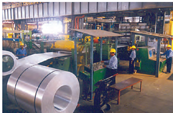
चित्र 6.6 – नाल्को प्रगालक में पट्टी लेप मिल
