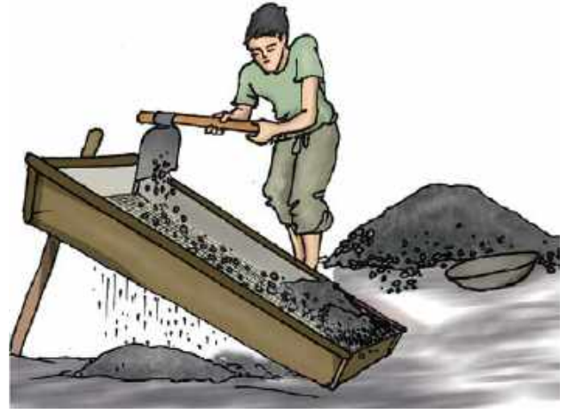
આકૃતિ 5.7 મોટા કાંકરા અને પથ્થરોને ચાળવાની ક્રિયા દ્વારા રેતીમાંથી દૂર કરવામાં આવે છે
