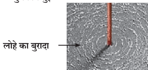
4.6 विद्युत धारा के कारण चालक के परितः निर्मित होनेवाला चुंबकीय क्षेत्र
