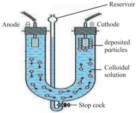
Fig. 11.10 : Electrophoresis
