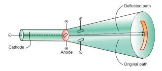
Fig. 4.1 : Cothode ray tube experiment
