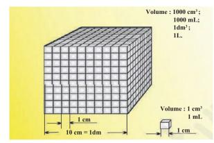
Fig. 1.2 : Litre and SI unit of volume
