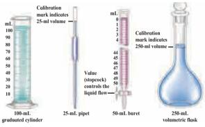
Fig. 1.3 : Volumetric glass apparatus
