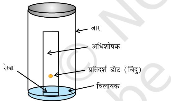
चित्र 8.12 (क) थिन लेयर क्रोमेटोग्रैफी में क्रोमेटोग्राम का विकसित होना।
