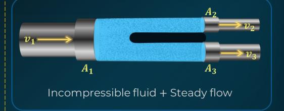
$$A_1 v_1 = A_2 v_2 + A_3 v_3$$
